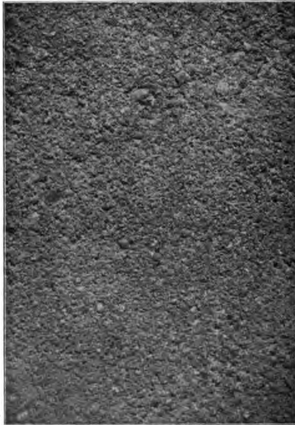
Abb. 125. Vorsetzbeton, gewaschen und abgebürstet. 1 Teil Zement, 3 Teile gelber Flußsand.
